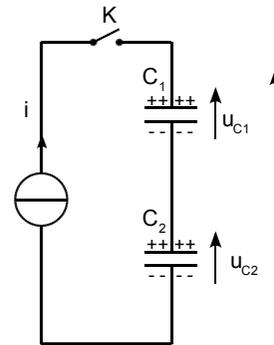
La source de courant délivre une intensité constante  $i = 40 \mu\text{A}$ .
