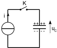
La source de courant délivre une intensité constante  $i = 40 \mu\text{A}$ .
