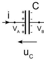
Un condensateur est constitué de 2 armatures métalliques séparées entre-elles par un isolant.
