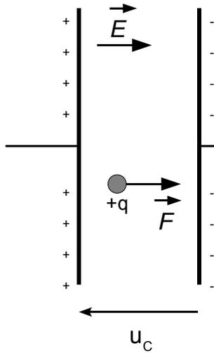
On définit le vecteur champ électrique  $\vec{E}$  l'ensemble des ligne de champs électriques comprises entre les deux armatures du condensateur séparée d'une épaisseur e en [m].
