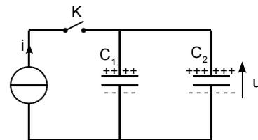
La source de courant délivre une intensité constante  $i = 40 \mu\text{A}$ .
