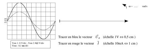
2- On observe à l'oscilloscope la tension u<sub>L</sub> aux bornes d'une inductance L sur la voie 1 (référence des phases) et l'allure du courant qui la traverse à travers une résistance de visualisation de  $10 \Omega$ .
