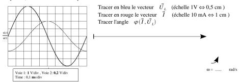
3- On observe à l'oscilloscope la tension u<sub>C</sub> aux bornes d'un condensateur C sur la voie 1 (référence des phases) et l'allure du courant qui le traverse à travers une résistance de visualisation de  $10\,\Omega$  .
