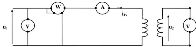
Remarque : le courant  $i_{1v}$  n'étant pas sinusoïdal, il faut utiliser un ampèremètre TRMS.
