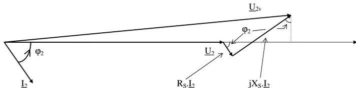
On peut, à partir de ce diagramme déterminer la chute de tension  $\Delta U_2 = U_{2v} - U_2$  soit
