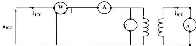
Cet essai se fait **sous tension au primaire réduite** c'est-à-dire que l'on règle la tension  $u_1$  jusqu'à ce que la **valeur efficace du courant  $i_2$  soit celui du courant  $I_{2N}$** .
